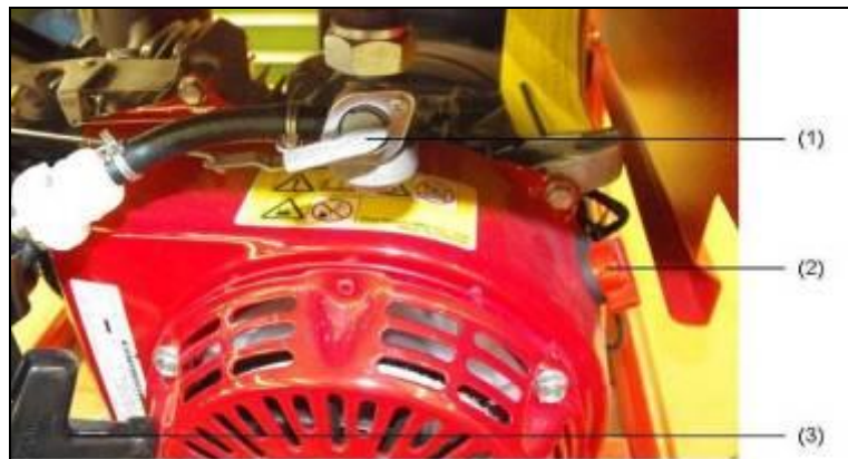
4.1. ábra: Üzemanyag csap nyitása / zárása
