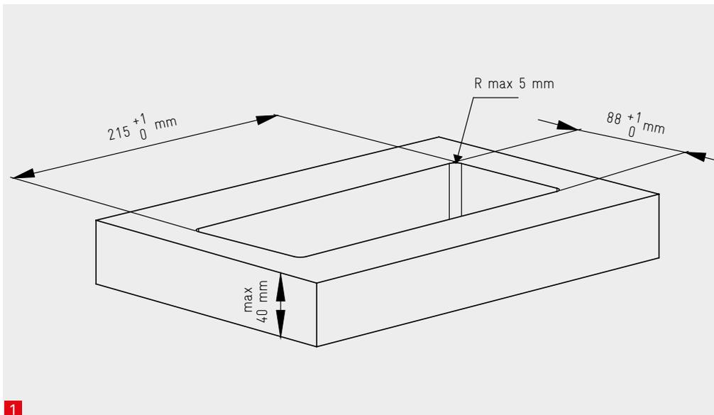
Der EVoline BackFlip kann an jeder beliebigen Position in die Arbeitsplatte (bis max. 40 mm Stärke) eingebaut werden. Bei Einbau über Schränken oder Schubladen werden diese in ihrer Funktion nicht beeinträchtigt. Der Arbeitsplatzausschnitt muss mit einem Mindestabstand von 50 mm zu Arbeitsplattenkanten platziert werden.
