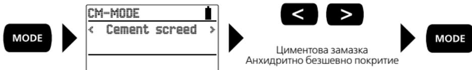
Режимът CM анализира влажността на материала подобно на метода за измерване с калциев карбид. Той работи на химичен принцип, като взетите проби от строителните материали се проверяват за наличие на влага в съд под налягане. В режим CM MoistureMasterCompact Plus показва сравнителна стойност в CM% чрез безразрушителен електронен метод за измерване.
