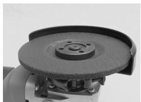
Bei Scheiben mit geringerer Stärke muss der Flansch mit dem Bund nach außen aufgeschraubt werden.
