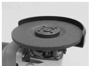
Si vous utilisez des disques d'une épaisseur dépassant 4 mm sur le raccord de la machine, vissez la flasque extérieure avec le centre en saillie dirigé vers l'intérieur, comme indiqué sur l'image.
