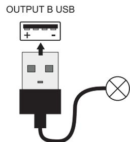
Schließen Sie den Verbraucher an Ausgang B USB-B1 (33) an und schalten Sie ihn ein. Achten Sie auf die Polarität. Der maximale Stromwert beträgt 2,5 A, eine Strombegrenzung löst bei Überschreitung dieser Ausgänge automatisch aus. Die USB-Buchse ist standardmäßig beschaltet. Die Skizze zeigt die Kontaktierung.
