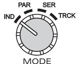
Um die Betriebsart zu Wählen, drehen Sie den Drehschalter „MODE“ (32) in die entsprechende Position.
