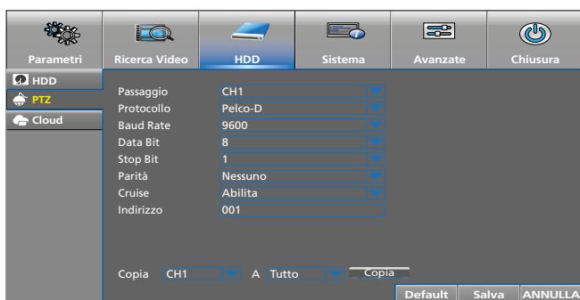
Fig. 6-26 Menu per impostare il comando remoto delle telecamere
