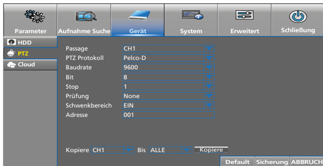
Abb. 6-23 Menü zum Einstellen der Kamerafernsteuerung
