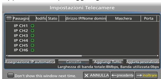
Fig. 6-15 Inserimento di telecamere di rete
