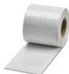
Kennzeichnungsstreifen, Rolle, weiß, unbeschriftet, beschriftbar mit: THERMOMARK ROLL 2.0, THERMOMARK ROLL, THERMOMARK ROLL X1, THERMOMARK ROLLMASTER 300/600, THERMOMARK X1.2, Montageart: kleben, für Klemmenbreite: 5 mm, Schriftfeldgröße: endlos x 5 mm, Anzahl der Einzelschilder: 90000
