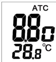
4. Drücken Sie den Hold Button um den aktuellen Messwert einzufrieren. Das Hold Symbol im Display erscheint und der Dezimalpunkt blinkt nicht mehr. Durch erneutes Drücken des Hold Buttons gelangen Sie wieder in den Messmodus.
