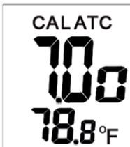
4. Falls die Elektrode defekt ist, die Elektrode nicht korrekt in der Lösung eingetaucht ist oder die Lösung eine falsche Spannung besitzt erscheint automatisch nach 10 Sek. END im Display und das Gerät verlässt den Kalibriermodus.
