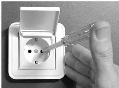
→ Auf diese Weise können Sie z.B. bei einer Steckdose schnell feststellen, an welcher Öffnung die Phase L anliegt.
