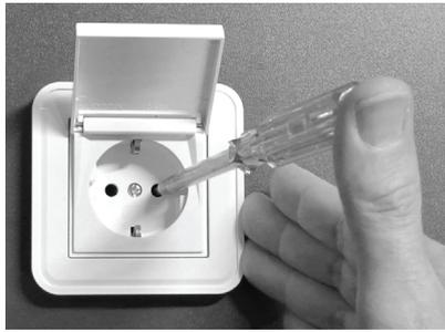
→ Op deze manier kunt u bijv. bij een contactdoos snel vaststellen aan welke opening de fase L wordt toegepast.
