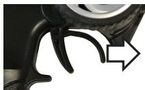
→ Wechseln Sie nicht sofort zwischen den Fahrtrichtungen, sondern stoppen Sie das Fahrzeug zuerst, bevor Sie in die jeweils andere Richtung fahren. Ein direkter Wechsel der Fahrtrichtung kann zu einer Überlastung des Getriebes führen.
