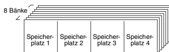
Es können bis zu 32 Einstellungen (acht Bänke mit jeweils vier) gespeichert werden.
