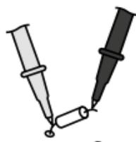
Las resistencias sólo pueden ser medidas correctamente por separado, por eso eventualmente habrá que separar los componentes de la conexión restante.
