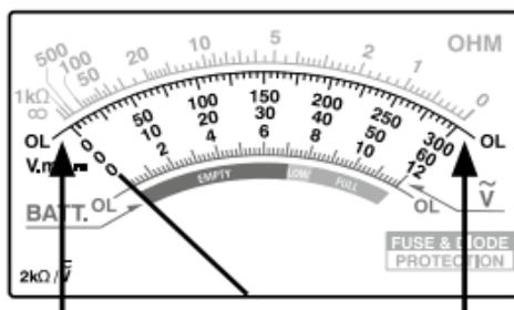
Bleibt der Zeiger während der Messung links von der „0“ bzw. bei Widerstandsmessungen rechts von der „0“ stehen, sind die Messspitzen vertauscht oder der Messkreis ist unterbrochen. Führen Sie die Messung erneut mit getauschten Messspitzen durch.
