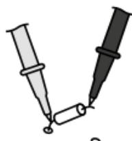
Weerstanden kunnen alleen separaat correct worden gemeten, daarom moeten beide onderdelen eventueel van de resterende schakeling worden gescheiden.
