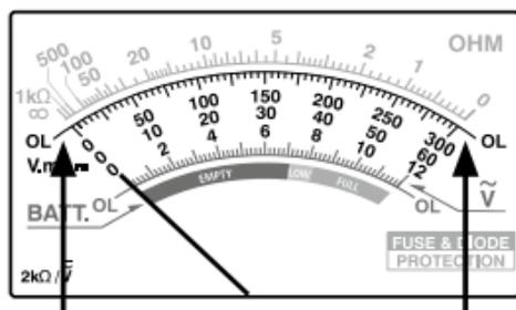
Si, pendant la mesure, l'aiguille reste à gauche de « 0 » ou, pendant la mesure de la résistance à droite de « 0 », les pointes de mesure ont été interverties ou le circuit de mesure est interrompu. Effectuer à nouveau la mesure en permutant les pointes de mesure.
