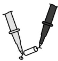
Les résistances ne peuvent être mesurées correctement que séparément, c'est pourquoi il faut éventuellement débrancher les composants du reste du circuit.
