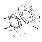
$\bullet$  Montieren Sie Adapter 4 mithilfe der mitgelieferten Schrauben, Unterlegscheiben und Muttern.
