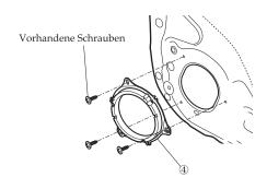
• Montieren Sie Adapter 4 unter Verwendung der vorhandenen Schrauben.
