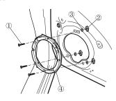
$\bullet$  Montieren Sie Adapter  $\ \textcircled{4}$  mithilfe der mitgelieferten Schrauben, Unterlegscheiben und Muttern.
