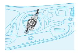
• Montieren Sie den Hochtöner an der originalen Position im Armaturenbrett und verwenden Sie dafür die vorhandenen Originalschrauben.
