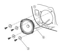
• Installieren Sie den Lautsprecher mithilfe der vorhandenen Schrauben und des mitgelieferten Lautsprecherkabels ⑥.
