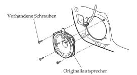
• Vorhandene Schrauben, Steckverbinder und Originallautsprecher herausnehmen.
