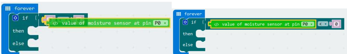
Ustawić wartość funkcji logicznej **smaller than** na 50. Zmienić **value of moisture sensor at pin P0** na **P1**. Kod powinien wyglądać jak na ilustracji poniżej.
