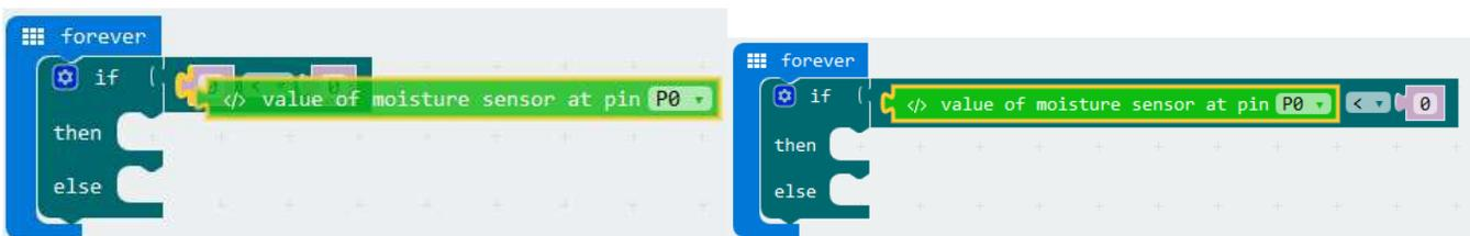
Stel de waarde van **smaller than** in op 50. Verander de waarde van het blokje **value of moisture sensor at pin P0** naar **P1**. De code ziet er uit als volgt:
