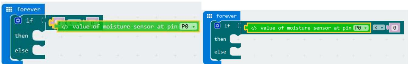
Régler la valeur de la fonction **smaller than** sur 50. Régler **value of moisture sensor at pin P0** sur **P1**. Le code devrait ressembler à l'illustration ci-dessous.
