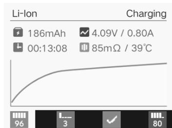
→ Das Ladegerät ist mit einer Funktion zur Messung des Innenwiderstandes einzelner Zellen ausgestattet. Der Innenwiderstand wird nach ca. 10 s gemessen und berechnet, nachdem das Ladeprogramm gestartet wurde. Der sehr geringe Innenwiderstandswert kann bei verschiedenen Ladeparametern kleine Abweichung aufweisen. Dies ist messtechnisch bedingt und keine Fehlfunktion.
