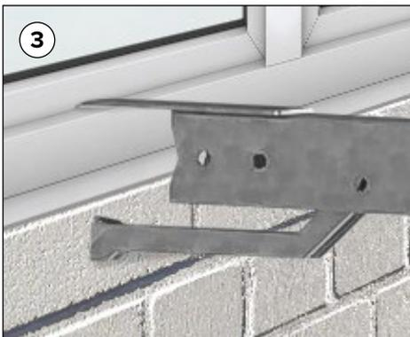
Hängen Sie die Antenne mit der **Fensterhalterung A** in die Falz des Fensters. Die **Fensterhalterung B** dient hierbei als Stütze. Mit den beiden **Befestigungsschrauben M6 x 10** an der **Fensterhalterung A**, können Sie den Abstand vom Fenster zur Außenwand einstellen. Der **Befestigungsarm** sollte in der Regel waagrecht angebracht sein.
