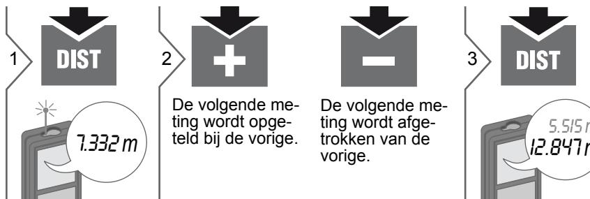
**i** Het resultaat staat op de hoofdregel en de gemeten waarde er boven. Dit proces kan zo vaak als nodig worden herhaald. Dezelfde procedure kan worden gevolgd voor optellen en aftrekken van oppervlakten en volumes.
