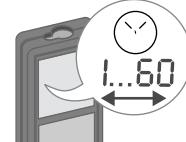
Sekunderna räknar ner till mätningen när tangenten släpps med aktiv laser. Födröjd utlösning rekommenderas för exakt inriktning, t.ex. vid långa avstånd. Det undviker att instrumentet skakar när man trycker på mätknappen.
