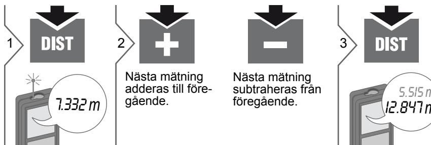
**i** Resultatet visas i huvudraden och uppmätt värde ovanför. Upprepa detta vid behov. Samma tillvägagångssätt kan användas för att lägga till eller subtrahera areor eller volymer.
