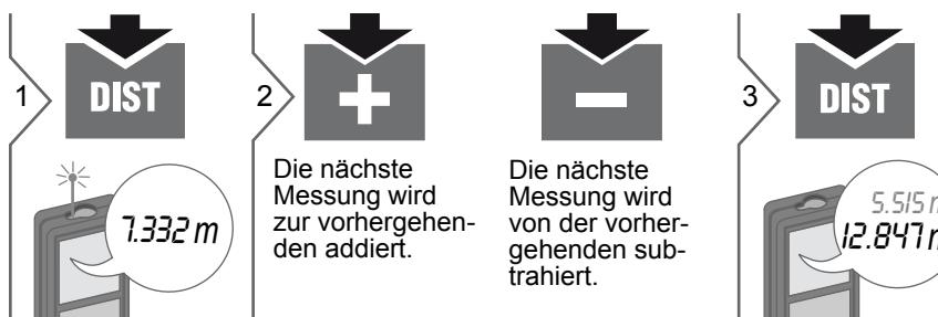
i Das Ergebnis wird in der Hauptzeile, der Messwert darüber angezeigt. Dieses Vorgehen bei Bedarf wiederholen. Anhand dieser Vorgangsweise können auch Flächen oder Volumen addiert und subtrahiert werden.
