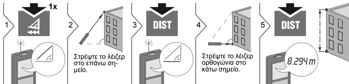
**i** Το αποτέλεσμα εμφανίζεται στην κεντρική γραμμή και η μετρηθείσα τιμή εμφανίζεται από πάνω. Πατώντας το πλήκτρο μέτρησης επί 2 δευτ. στη λειτουργία ενεργοποιείται αυτόματα η μέτρηση Ελάχιστης ή η Μέγιστρης απόστασης.
