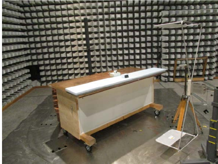
Messaufbau in der Messzelle / Test setup in the anechoic chamber (20 – 200 MHz)
