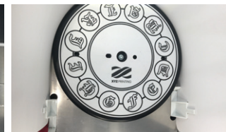
L'installation de la plaque d'ombrage est terminée.
