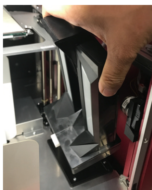
Fixez le module de numérisation verticalement à la base.
