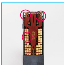
Cartucho en mal estado (cable y superficie dañados)
