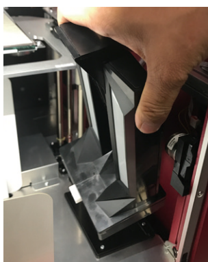
Conecte el módulo de escaneo a la base verticalmente.
