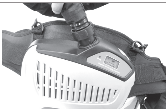
Sluit de luchtslang aan op het filtersysteem en draai deze aan in de richting van de wijzers van de klok om hem te blokkeren.
