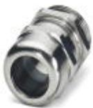
Kabelverschraubung, Material Verschraubung: Messing, vernickelt, Kabelaußendurchmesser 15 mm ... 21 mm, Schirmung: nein, Anschlussgewinde: M32 x 1,5, Farbe: silberfarben, mit O-Ring
