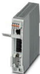
PoE-Injektor, 60 W, RJ45-Buchse auf IDC-Klemmen, 10/100/1000 MBit/s, Tragschienenmontage, IP20, Potenzialtrennung, Schirmkontaktierung mit Zugentlastung, Schirmstromüberwachung, Überspannungsschutz
