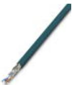
CAT5-SF/UTP-Kabel (J-LI02YS(ST)C H 2 x 2 x 26 AWG), leichtes, flexibles Installationskabel 2 x 2 x 0,14 mm<sup>2</sup>, feindrätig, geschirmt, Außenmantel: 5,75 mm ± 0,15 mm Durchmesser
