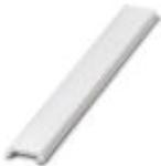
Zackband flach, Streifen, weiß, unbeschriftet, beschriftbar mit: PLOTMARK, CMS-P1-PLOTTER, Montageart: verrasten in flacher Schildchennut, für Klemmenbreite: 10,15 mm, Schriftfeldgröße: 4 mal 10,15 x 5 mm und 1 mal 5,8 x 5 mm, Anzahl der Einzelschilder: 50
