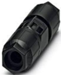
Leitungsverbinder, QUICKON-Anschluss, Polzahl: 2+PE, 0,5 mm<sup>2</sup> ... 1,5 mm<sup>2</sup>, 690 V, 17,5 A, schwarz, mit zwei QUICKON-Muttern, Kabeldurchmesserbereich: 5 mm ... 9,5 mm, QUICKON-Schnellanschluss
