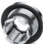
M12-Gewindehülse mit toleranzausgleichender Funktion, für gerade, SMD-fähige M12-Buchsenkontakteinsätze. Geeignet für Frontplattenwandstärken von 2,3 mm ... 3,0 mm.
