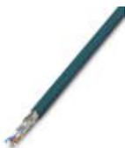
CAT5-SF/UTP-Kabel (J-LI02YS(ST)C H 2 x 2 x 26 AWG), leichte, flexibles Installationskabel 2 x 2 x 0,14 mm<sup>2</sup>, feindrätig, geschirmt, Außenmantel: 5,75 mm ± 0,15 mm Durchmesser, beidseitig konfektioniert mit RJ45-Stecker, crossover oder line Belegung
