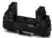
Basiselement für Schutzstecker PT mit Schutzschaltung für einen 4-adrigen erdpotenzialfrei betriebenen Signalkreis, Gasableiter zwischen den Anschlüssen 3-4 (GND) und 9-10, Montage auf NS 35/7,5 und NS 35/15, Gehäusebreite: 17,5 mm
