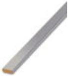
N-Sammelschiene, Breite: 10 mm, Höhe: 3 mm, DIN VDE 0611-4: 1991-02, Material: Kupfer, verzinkt, Länge: 2000 mm, Farbe: silberfarben
