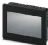
Touch-Panel mit 10,92 cm / 4,3"-TFT-Display (analog-resistiv (Polyester)), 480 x 272 Pixel (WQVGA), 262144 Farben, Arm9™ i.MX28, 454 MHz, 2x COM (RS-232/422/485), 1x USB 2.0, Typ A, 1x USB 2.0, Typ B, 1x Ethernet (10/100 MBit/s), RJ45, Windows® CE 6.0 und Anwendersoftware: Visu+. (Bussystem: ohne)
