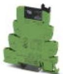
PLC-INTERFACE für Eingabefunktionen bei PLC logic, mit Push-in-Anschluss und steckbarem Miniatur-Solid-State-Relais, zur Montage auf Tragschiene NS 35/7,5, 1 Schließer, Eingang: 24 V DC, Ausgang: 3-48 V DC/100 mA
