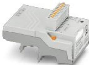
PLC logic Stand-alone Logikmodul, Generation 2, mit 16 I/Os, steckbar auf 8 digitale oder analoge PLC-INTERFACE-Klemmen, nicht erweiterbar, Echtzeituhr, Micro-USB Buchse, Aufnahme für Speicherbaustein und Bluetooth Adapter, Push-in-Anschluss
