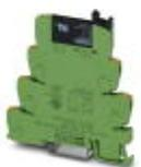
PLC-INTERFACE für Eingabefunktionen bei PLC logic, mit Push-in-Anschluss und steckbarem Miniatur-Solid-State-Relais, zur Montage auf Tragschiene NS 35/7,5, 1 Schließer, Eingang: 120 V AC/110 V DC, Ausgang: 3-48 V DC/100 mA
