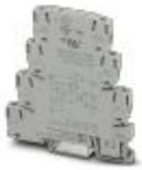
PLC-INTERFACE mit Rückmeldekontakt, bestehend aus Grundklemme mit Schraubanschluss und integriertem Miniatur-Solid-State-Relais, zur Montage auf Tragschiene NS 35/7,5, 1 Schließer, Eingang: 24 V DC, Ausgang: 3 ... 33 V DC/10 A
