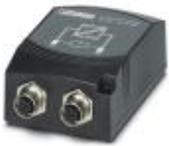
Passiver Netzwerkisolator zur galvanischen Trennung in Ethernet-Netzwerken. Zum Schutz von Ethernet-Geräten vor Potenzialunterschieden bis 4 kV. Einsetzbar für Übertragungsraten bis 100 MBit/s. Ethernet-Anschluss über zwei M12-Buchsen (D-kodiert).
