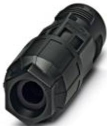
Leitungsverbinder, QUICKON-Anschluss, Polzahl: 4+PE, 0,5 mm<sup>2</sup> ... 1,5 mm<sup>2</sup>, 690 V, 17,5 A, schwarz, mit einer QUICKON-Mutter, Kabeldurchmesserbereich: 9 mm ... 14 mm
