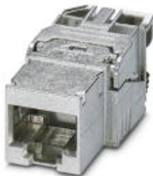
RJ45-Buchseneinsatz, Bauform: RJ45, Schutzart: IP20, Polzahl: 8, 10 GBit/s, CAT6<sub>A</sub>, Material: Zink-Druckguss, Anschlussart: IDC-Anschluss, Anschlussquerschnitt: AWG 26- 22, Kabelabgang: gerade, adapterlose Ausführung
