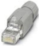
RJ45-Steckverbinder, Schutzart: IP20, Polzahl: 8, 1 GBit/s, CAT5 (IEC 11801:2002), Material: PA, Anschlussart: IDC-Schnellanschluss, Anschlussquerschnitt: AWG 26- 23, Kabelabgang: gerade, Farbe: verkehrsgrau A RAL 7042
