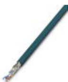
CAT5-SF/UTP-Kabel (J-LI02YS(ST)C H 2 x 2 x 26 AWG), leichte, flexibles Installationskabel 2 x 2 x 0,14 mm<sup>2</sup>, feindrätig, geschirmt, Außenmantel: 5,75 mm ± 0,15 mm Durchmesser, beidseitig konfektioniert mit RJ45-Stecker, crossover oder line Belegung
