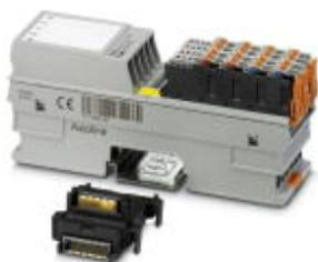
Axioline F XC, Analogausgabemodul, Analoge Ausgänge: 4, 0 V ... 5 V, -5 V ... 5 V, 0 V ... 10 V, -10 V ... 10 V, 0 mA ... 20 mA, 4 mA ... 20 mA, Anschlusstechnik: 2-Leiter, Übertragungsgeschwindigkeit im Lokalbus: 100 MBit/s, Extreme Conditions-Variante, Schutzart: IP20, inklusive Bussockelmodul und Axioline F-Steckern
