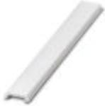
Zackband flach, Streifen, weiß, unbeschriftet, beschriftbar mit: PLOTMARK, CMS-P1-PLOTTER, Montageart: verrasten in flacher Schildchennut, für Klemmenbreite: 10,15 mm, Schriftfeldgröße: 4 mal 10,15 x 5 mm und 1 mal 5,8 x 5 mm, Anzahl der Einzelschilder: 50
