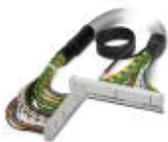
Konfektioniertes, geschirmtes Rundkabel; Anschluss 1: IDC/FLK-Buchsenleiste (1x 50-polig); Anschluss 2: IDC/FLK-Buchsenleiste (1x 50-polig) (Das Schirmgeflecht ist auf ein separates Kabelende herausgeführt.); Kabellänge: 6 m
