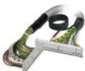
Konfektioniertes, geschirmtes Rundkabel; Anschluss 1: IDC/FLK-Buchsenleiste (1x 50-polig); Anschluss 2: IDC/FLK-Buchsenleiste (1x 50-polig) (Das Schirmgeflecht ist auf ein separates Kabelende herausgeführt.); Kabellänge: 10 m
