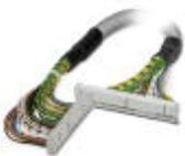
Konfektioniertes, halogenfreies Rundkabel; Anschluss 1: IDC/FLK-Buchsenleiste (1x 50-polig); Anschluss 2: IDC/FLK-Buchsenleiste (1x 50-polig); Kabellänge: 4 m
