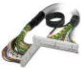
Konfektioniertes, geschirmtes Rundkabel; Anschluss 1: IDC/FLK-Buchsenleiste (1x 50-polig); Anschluss 2: IDC/FLK-Buchsenleiste (1x 50-polig) (Das Schirmgeflecht ist auf ein separates Kabelende herausgeführt.); Kabellänge: 1,5 m
