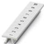
Repérage ZB, Rubans, blanc, repéré, impression longitudinale: numérotation continue 1 ... 10, 11 ... 20, etc. jusqu'à 491 ... 500, type de montage: encliquetage dans la rainure de repérage élevée, pour bloc de jonction au pas de : 5,2 mm, surface utile: 5,15 x 10,5 mm
