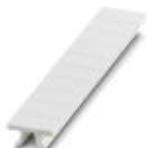
Repérage ZB, à commander : par bandes, blanc, impression selon les indications du client, type de montage: encliquetage dans la rainure de repérage élevée, pour bloc de jonction au pas de : 5,2 mm, surface utile: 5,15 x 10,5 mm
