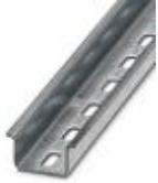
Profilé percé, Profil standard, largeur: 35 mm, hauteur: 15 mm, similaire à EN 60715, matériau: Acier, galvanisé, longueur: 2000 mm, coloris: argenté
