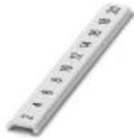
Repérage ZB, plat, Rubans, blanc, repéré, impression longitudinale: numérotation continue 2 ... 20, 22 ... 40, etc. jusqu'à 82 ... 100, type de montage: encliquetage dans la rainure de repérage plate, pour bloc de jonction au pas de : 5 mm, surface utile: 5,15 x 5,15 mm
