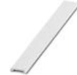
Repérage ZB, plat, Rubans, blanc, vierge, repérable avec : PLOTMARK, CMS-P1-PLOTTER, type de montage: encliquetage dans la rainure de repérage plate, pour bloc de jonction au pas de : 5 mm, surface utile: 5,1 x 5,2 mm
