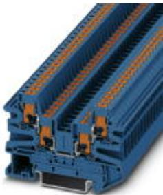
Bloc de jonction simple, tension nominale: 800 V, intensité nominale: 24 A, type de raccordement: Raccordement Push-in, nombre de connexions: 4, section : 0,14 mm<sup>2</sup> - 4 mm<sup>2</sup>, AWG: 26 - 12, largeur: 5,2 mm, hauteur: 45,7 mm, coloris: bleu, type de montage: NS 35/7,5, NS 35/15
