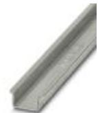
Profilé plein, Profil standard 2,3 mm, largeur: 35 mm, hauteur: 15 mm, selon EN 60715, matériau: Acier, galvanisé, traité par passivation couche épaisse, longueur: 2000 mm, coloris: argenté
