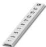
Repérage ZB, plat, Rubans, blanc, repéré, impression longitudinale: numérotation impaire 1-19, 21-39, etc. jusqu'à 81-99, type de montage: encliquetage dans la rainure de repérage plate, pour bloc de jonction au pas de : 5 mm, surface utile: 5,15 x 5,15 mm
