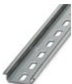
Profilé percé, Profil standard, largeur: 35 mm, hauteur: 7,5 mm, selon EN 60715, matériau: Acier, galvanisé, longueur: 2000 mm, coloris: argenté
