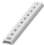
Repérage ZB, plat, Rubans, blanc, repéré, impression transversale: numérotation continue 1 ... 10, 11 ... 20, etc. jusqu'à 91 ... 100, type de montage: encliquetage dans la rainure de repérage plate, pour bloc de jonction au pas de : 5 mm, surface utile: 5,15 x 5,15 mm
