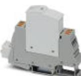
Überspannungsschutz Typ 2/3, bestehend aus Schutzstecker und Basiselement mit Push-in-Anschluss. Für einphasige Stromversorgungsnetze mit integrierter Statusanzeige und Fernmeldung. Nennspannung 230 V AC/DC.
