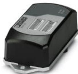
WLAN-Access-Point, Client mit zwei internen Antennen (MIMO) zur Einlochmontage, IP54, WLAN 802.11 a, b, g, n, Frequenz: 2,4 GHz, 5 GHz (inkl. DFS-Kanäle), Anschlüsse: COMBICON 9 ... 32 V DC, RJ45: für LAN, Web, http/https, Command Line Interface
