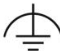
Anschluss des Schutz-Potenzialausgleichleiters
