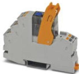
Vormontiertes Relaismodul mit Push-in-Anschluss, bestehend aus: Relaissockel, Relaisbühel und Leistungskontaktrelais mit Prüftaste, integrierter Status-LED und Freilaufdiode. Kontaktausführung: 2 Wechsler. Eingangsspannung: 24 V DC
