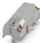
V8-Adapter für 8 x PLC-INTERFACE (14 mm), Steuerung: SPS-Systemverkabelung von Ausgangskarten, Anschluss 1: Schraubanschluss 1x, Anschluss 2: IDC/FLK-Stiftleiste 1x 14-polig, Anschluss 3: Steckanschluss (Aufraubar auf 8x PLC-INTERFACE-Klemmen), Anzahl der Kanäle: 8, Ansteuerlogik: plusschaltend
