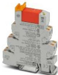
PLC-INTERFACE, bestehend aus tragschiennenmontabler Grundklemme in 14 mm mit Push-in-Anschluss und steckbarem Relais mit Leistungskontakt, 2-Wechsler, Eingangsspannung 24 V DC. Zugelassen nach ATEX/IECEX (Zone 2) und Ex-Zone Class I, Div. 2.
