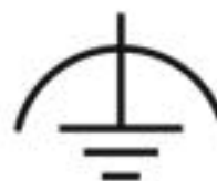
Przyłącze przewodu ochronnego wyrównania potencjałów
