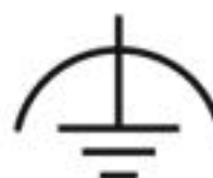
Anschluss des Schutz-Potenzialausgleichleiters
