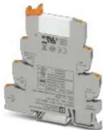
PLC-INTERFACE, bestehend aus Grundklemme PLC-BPT.../21 mit Push-in-Anschluss und steckbarem Miniaturrelais mit Mehrlagen-Goldkontakt, zur Montage auf Tragschiene NS 35/7,5, 1 Wechsler, Eingangsspannung 48 V DC
