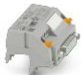
V8-Adapter für 8 x PLC-INTERFACE (6,2 mm), Steuerung: SPS-Systemverkabelung von Eingangskarten, Anschluss 1: Schraubanschluss 1x, Anschluss 2: D-SUB-Buchsenleiste 1x 15-polig, Anschluss 3: Steckanschluss (Aufrastbar auf 8x PLC-INTERFACE-Klemmen), Anzahl der Kanäle: 8, Ansteuerlogik: plusschaltend
