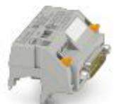
V8-Adapter für 8 x PLC-INTERFACE (6,2 mm), Steuerung: SPS-Systemverkabelung von Eingangskarten, Anschluss 1: Schraubanschluss 1x, Anschluss 2: D-SUB-Stiftleiste 1x 15-polig, Anschluss 3: Steckanschluss (Aufrastbar auf 8x PLC-INTERFACE-Klemmen), Anzahl der Kanäle: 8, Ansteuerlogik: plusschaltend
