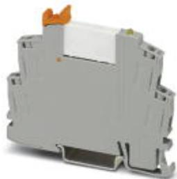
Vormontiertes Relaismodul mit Schraubanschluss, bestehend aus: Relaissockel mit Auswerfer und Leistungskontaktrelais. Kontaktausführung: 1 Schließer. Eingangsspannung: 24 V DC
