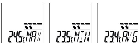
Käyttötilat Max/Min/AVG koskevat infrapunalämpötilanmittausta. Arvot näytävät infrapunalämpötilan maksimi-, minimi- ja keskiarvot. Max/Min/AVG-arvot näytetään mittauksen aikana laukaisunäppäintä (9) painamalla. Uuden mittauksen alussa (9) arvo poistetaan ja lasketaan uusi arvo.
