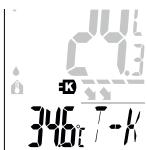
L'apparecchio commuta automaticamente nella modalità temperatura con contatto T-K non appena viene collegato un sensore di temperatura (tipo K). Fintanto che rimane collegato il sensore di temperatura, l'apparecchio non si spegne automaticamente se la carica della batteria è di almeno il 15%.
