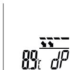
La temperatura del punto di rugiada è la temperatura al di sotto di cui si deve rimanere, affinché l'aria possa far precipitare il vapore acqueo sotto forma di goccioline, nebbia o rugiada. L'umidità da condensazione si forma, per esempio, quando una parete interna o un intradosso di finestra presentano una temperatura inferiore a quella di rugiada della stanza. Questi punti sono umidi e rappresentano un terreno di crescita per muffa oltre a causare danni al materiale.
