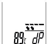
Kastepiste on lämpötila, jonka alapuolella ilman sisältämä vesihöyry tiivistyy pisaroiksi, usvaksi tai kasteeksi. Kondensaatioikosteutta esiintyy, kun sisäseinän tai ikkunan lämpötila alittaa huoneen kastepisteen. Nämä kohdat ovat kosteita ja muodostavat kasvualustan homeelle ja riskin muille aineellisille vahingoille.
