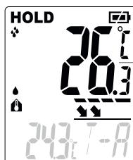
Indicação da temperatura por infravermelhos (em cada modo de medição)
