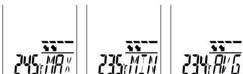
Os modos Max/Min/Avg referem-se à temperatura por infravermelhos e indicam respetivamente a temperatura por infravermelhos máxima, mínima ou média. Os valores Max/Min/Avg são calculados durante a medição corrente com o gatilho pressionado (9). Ao iniciar uma medição nova ou ao pressionar o gatilho (9), o valor é eliminado e novamente calculado.“
