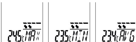
Modiene Maks. / min. / AVG er relatert til infrarød-temperaturen og viser i hvert tilfelle maksimum, minimum eller gjennomsnittlig infrarød-temperatur. Maks. / min. / AVG-verdiene beregnes under den løpende målingen mens utløseren (9) holdes trykket. Ved start av en ny måling eller ved å trykke på utløseren (9) slettes verdien, og den beregnes på nytt.
