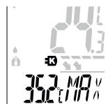
! Minimi- ja maksimiarvot poistetaan käyttötilaa vaihdettaessa ja laite pääälle / pois päältä kytettäessä.
