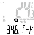
Laite kytkeytyy automaattisesti käyttötilaan Kosketuksellinen lämpötilanmittaus T-K, kun (K-typin) lämpötila-anturi liitetään laitteeseen. Lämpötila-anturin ollessa liitettynä, laite ei kytkeydy automaattisesti pois päältä, jos paristojen varauusta on vähintään 15%.
