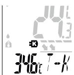
Instrumentet slår seg automatisk over i kontakt-temperaturmodus T-K så snart en temperaturføler (K-type) har blitt koplet til. Mens temperaturføleren er tilkoplet, slår instrumentet seg ikke automatisk av ved en batterilading på minst 15%.
