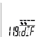
Denne modus er relatert til infrarød-temperaturen og beregner differansen mellom maksimum og minimum infrarød-temperatur for en løpende måling. Ved start av en ny måling eller ved å trykke på utløseren (9) slettes verdien, og den beregnes på nytt.
