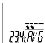
Lägena Max/Min/Avg refererar till infraröd-temperatur och visar maximal, minimal eller genomsnittlig infraröd-temperatur. Värdena Max/Min/Avg meddelas under löpande mätning när man trycker på utlösaren (9). När man startar en ny mätning resp. trycker på utlösaren (9) raderas värdet och beräknas på nytt.
