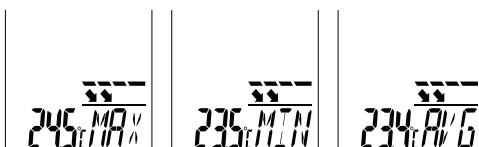
Tryby Max/Min/AVG odnoszą się do temperatury podczerwieni i wskazują kolejno temperaturę maksymalną, minimalną lub temperaturę średnią podczerwieni. Wartości Max/Min/AVG są ustalane podczas trwającego pomiaru przy naciśniętym przycisku włączenia (9). Po rozpoczęciu nowego pomiaru bądź naciśnięciu przycisku włączenia (9) wartość jest usuwana i obliczana na nowo.
