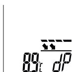
Temperatura punktu rosy jest to temperatura, poniżej której musi spaść wartość temperatury, aby powietrze mogło wydzielać zawartą parę wodną w formie kropelek, mgły lub rosy. Wilgoć kondensacyjna powstaje zatem np. wówczas, gdy ściana wewnętrzna lub framuga posiada niższą temperaturę niż temperatura punktu rosy pomieszczenia. Miejsca te są wówczas wilgotne i tworzą podłożę dla pleśni oraz przyczyniają się do uszkodzenia materiału.
