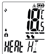
температура на обкръжението: 12°C топлинен мост, дисплей светва в червено и се подава звук сигнал
