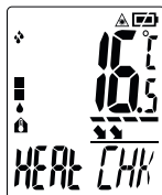
температура на обкръжението: 20°C евентуално наличие на топлинен мост, допълнителна проверка на зоната
