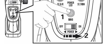
Nach ca. 3-5 Sekunden leuchtet die Kontrollleuchtet an der Fernbedienung dauerhaft und die Kontrollleuchte im Boot blinkt schnell. Der Bindevorgang ist abgeschlossen und das Boot ist bereit.
