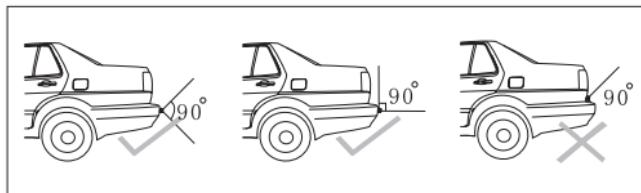
Die Sensoren müssen gleichmäßig über die Fahrzeugsbreite verteilt montiert werden.
