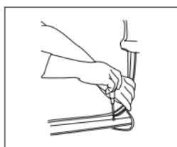
Bevestig de besturingseenheid m.b.v. het meegeleverde kleefpad. Een geschikte plaats hiervoor is de zijwand in de waterdichte kofferruimte in de buurt van een achteruitrijlamp. Let op dat de aansluitkabels van de sensoren lang genoeg zijn om de sensoreenheid te bereiken.
