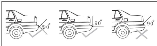
Les capteurs doivent être montés en les répartissant de manière régulière sur toute la largeur du véhicule.
