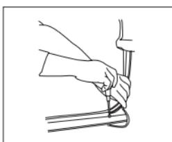
Befestigen Sie die Steuereinheit mittels beiliegendem Klebepad. Eine geeignete Stelle ist die Seitenwand im wassergeschützten Kofferraum in der Nähe einer Rückfahrlampe. Achten Sie darauf, dass die Anschlussleitungen der Sensoren zur Sensoreinheit reichen.
