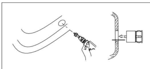
Percez les trous pour les quatre capteurs ultrasoniques à l'aide du perforateur de 21 mm fourni.
