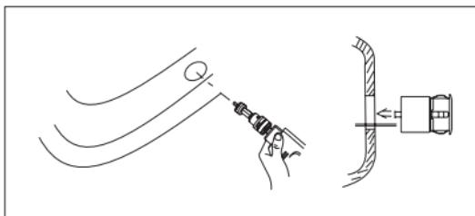
Bohren Sie die Löcher der vier Ultraschallsensoren mit dem beiliegendem 21-mm-Lochbohrer.
