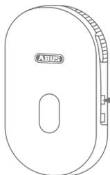
Drücken Sie die Pairing Taste für mindestens 3 Sekunden bis die LED blau blinkt. Der Sprachbefehl „Bereit für Kameraverbindung“ wird abgespielt. Falls die Kamera bereits in einer Basisstation eingelernt ist, löschen Sie diese bitte vorab aus der Liste.
