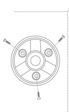
Bohren Sie anhand der Bohrschablone die Löcher vor und schrauben Sie mithilfe des Montagematerials die Bodenplatte fest.
