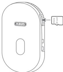
Für eine Aufzeichnung benötigen Sie eine MicroSD-Karte. Diese ist optional erhältlich. Bitte legen Sie diese ein und achten Sie darauf, dass diese einrastet.
