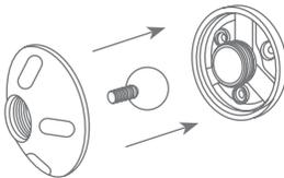
Setzen Sie das Kugelgelenk ein und schrauben Sie die Abdeckung auf, bitte ziehen Sie diese nicht fest um im Anschluss die Kamera auszurichten.
