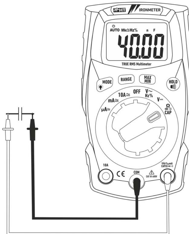
Fig. 7: Uso dello strumento per misura di Capacità
